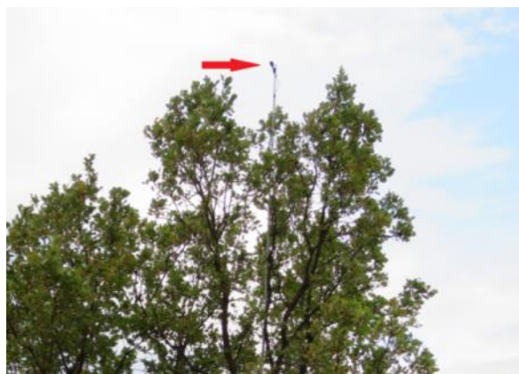
Slika 6 Mikrofon ultrazvučnog detektora postavljen iznad vegetacije na točki praćenja (Autor: G. Rnjak)
