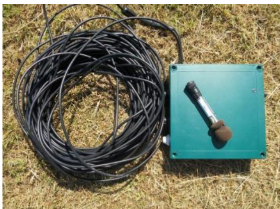
Slika 5 SM2BAT+ ultrazvučni detektor korišten za snimanje glasanja šišmiša (Autor: D. Rnjak)
